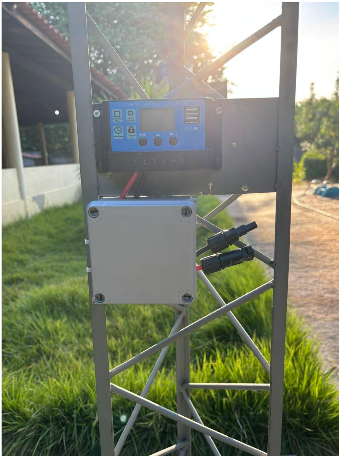
Figura 3: ilustra o controlador de carga 30A usb 12/24v (Marco Antônio Mendes, 2025)
